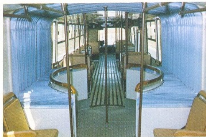
Detalhe da área de articulação, observando-se o revestimento interno e apoios para total segurança dos passageiros.
