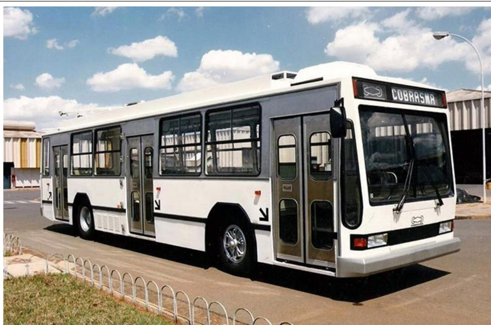
O protótipo de trólebus desenvolvido pela Cobrasma, com equipamentos elétricos e eletrônicos fornecidos pela BBC. Este veículo foi adquirido pelo sistema de trólebus de Araraquara, no interior do estado de São Paulo.
