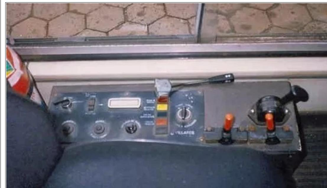
(Painel de comando do sistema de tração e auxiliares do trólebus
