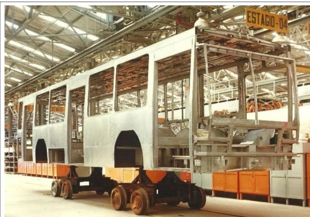
A Cobrasma lançou mão do domínio que possuía na tecnologia de construção de carros de trens e metrô em aço inoxidável, apresentando em seus trólebus uma carroceria monobloco confeccionada neste material. Chapas finas de aço dobradas e transformadas em elementos tridimensionais asseguravam a rigidez do conjunto.
