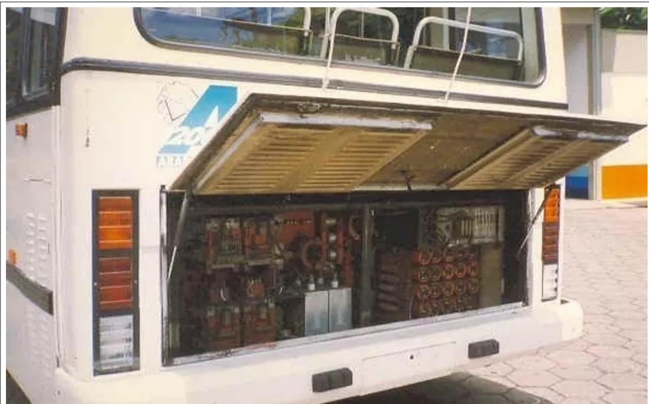
Sistema chopper, instalado na traseira do trólebus Cobrasma/Villares - nº43.
