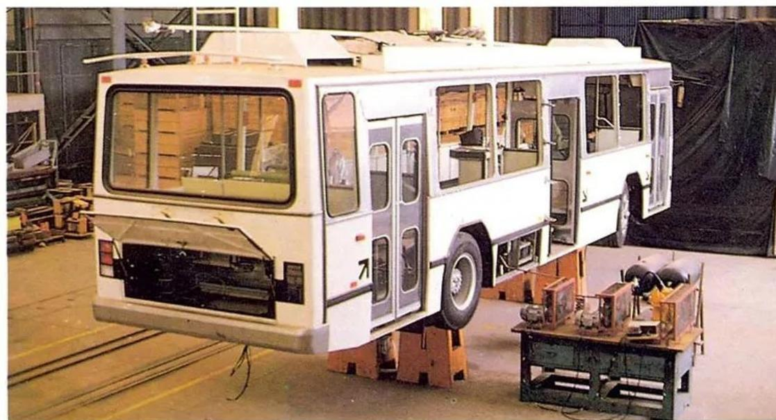
*O protótipo de trólebus desenvolvido pela Cobrasma, com equipamentos elétricos e eletrônicos fornecidos pela BBC, em montagem.
