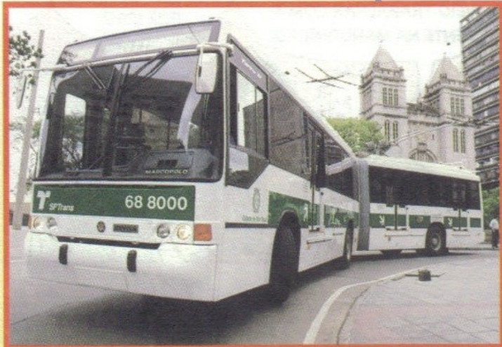
O primeiro (esq.) e o segundo protótipos do “Fura-Fila”: na verdade, trolebus antigos que o Eletrobus reformou e implementou diversos equipamentos que seriam utilizados no VLP
