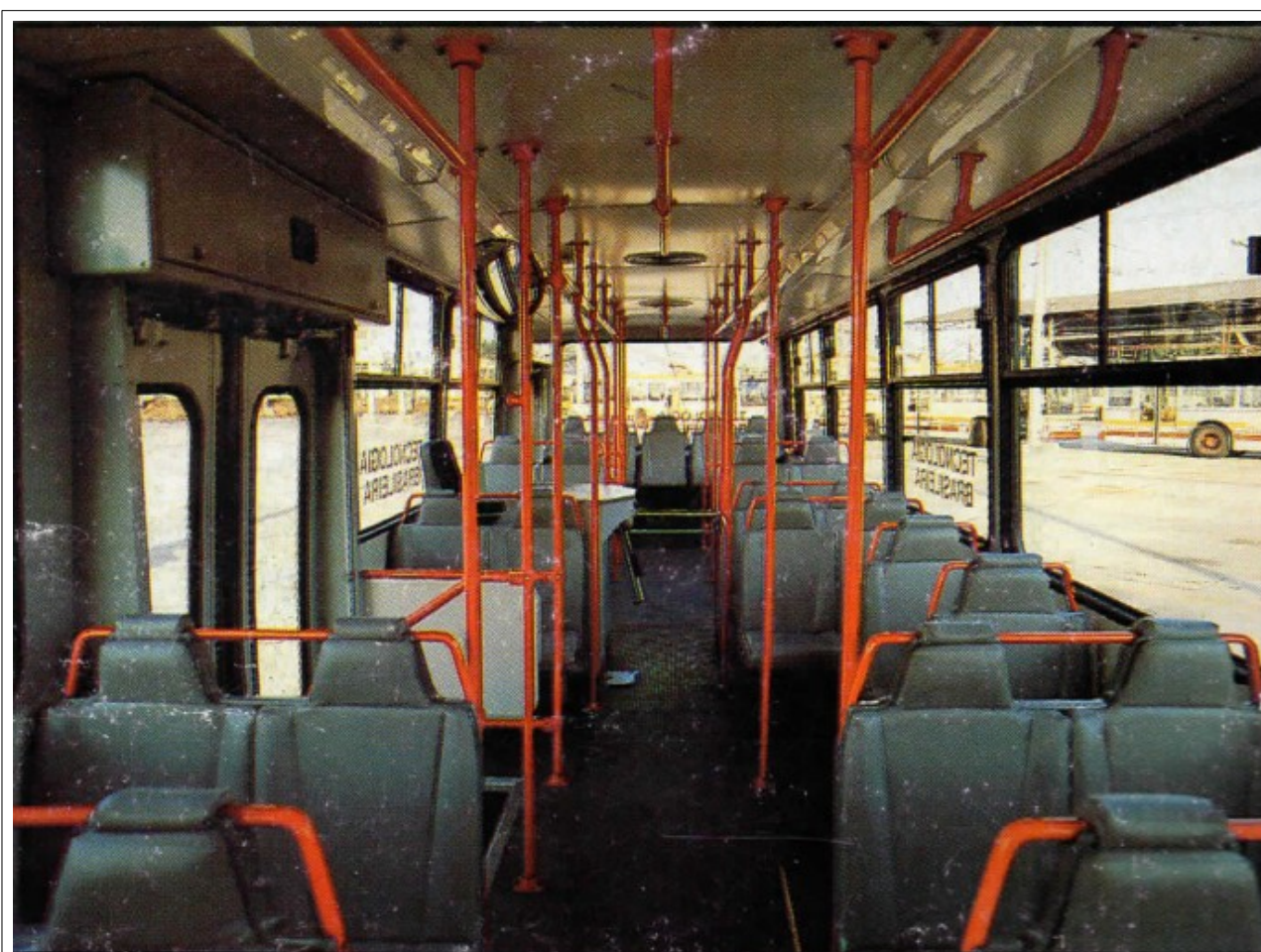
Salão de passageiros do trólebus monobloco Mafersa/Villares - protótipo padron. (Folheto "Trólebus Mafersa - Trólebus de 2 Eixos com Estrutura Integrada em Módulos")
