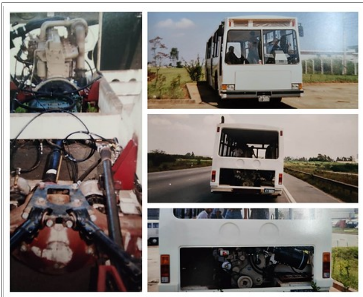
O ônibus convencional diesel Mafersa surgiu a partir do projeto dos trólebus Mafersa. O protótipo inclusive foi montado em uma plataforma de trólebus, conforme observa-se nas imagens acima. (Acervo Hélio Ronzani)
