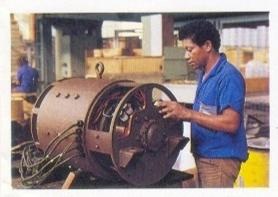
O motor elétrico, fabricado por Indústrias Villares, se constitui na mais avançada versão para ônibus elétrico, com excitação independente.
