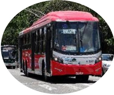
.50 Veículos Trólebus Padron Piso Baixo de 15 metros de comprimento sem SAT - Sistema de Autonomia de Tráfego;
