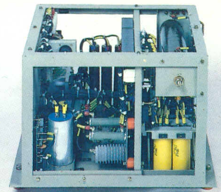
7-recortador de campo do motor-motor field chopper
