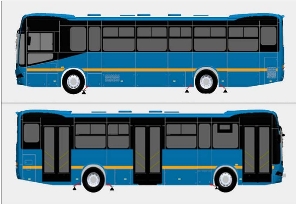
Figura 1-1: Pontos de apoio para elevação do veículo
