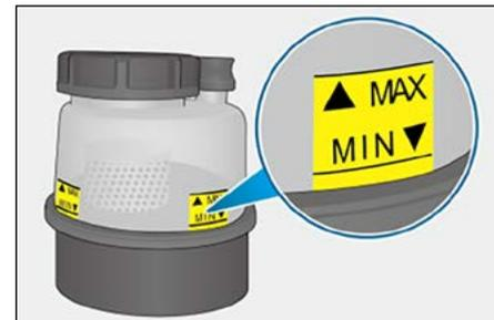
A nível do fluido do sistema de direção deve ser mantido entre as escalas **MAX** e **MIN**.
