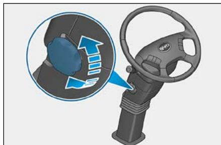
O volante pode ser inclinado para a frente ou para trás. Para isso, gire o manípulo conforme indicado na figura.
