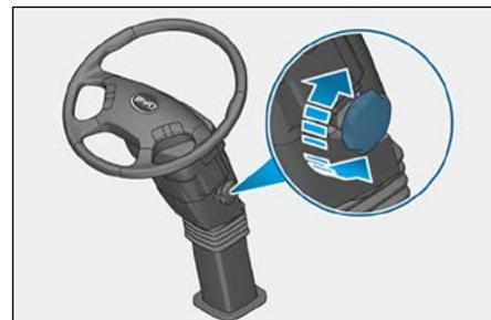
O volante pode ser ajustado para cima e para baixo. Para isso, gire o manípulo conforme indicado na figura.
