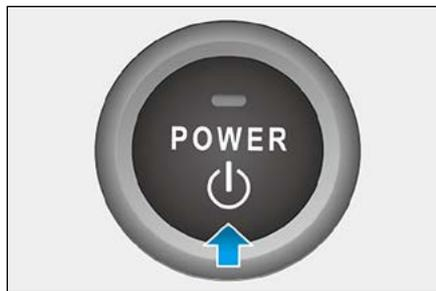
Quando for necessário desligar a energia do veículo em uma emergência, isso pode ser feito pressionando e segurando o botão **POWER** (ligar/desligar) por mais de 3 segundos.
